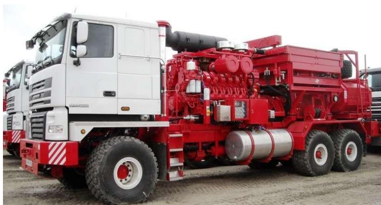
1 Сурет - FC-2251 «Стюарт и Стивенсон» (АҚШ) компаниясының сорапты қондырғысы
